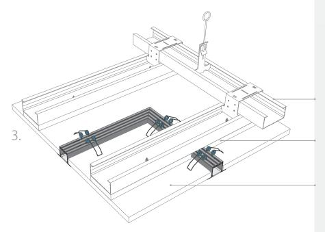
konstrukcja nośna sufitu support structure of the ceiling
